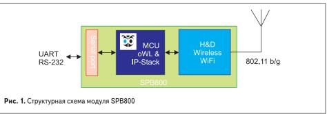
встроенного процессора. Такое сочетание сводит к минимуму количество необходимых внешних компонентов, упрощает монтаж и отладку. Для связи с внешним хост-процессором имеются интерфейсы SDIO/UART и SPI.
